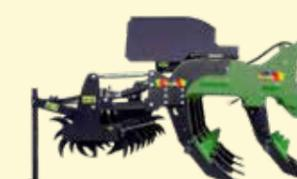
Con doppio rullo dentato a regolazione idraulica
