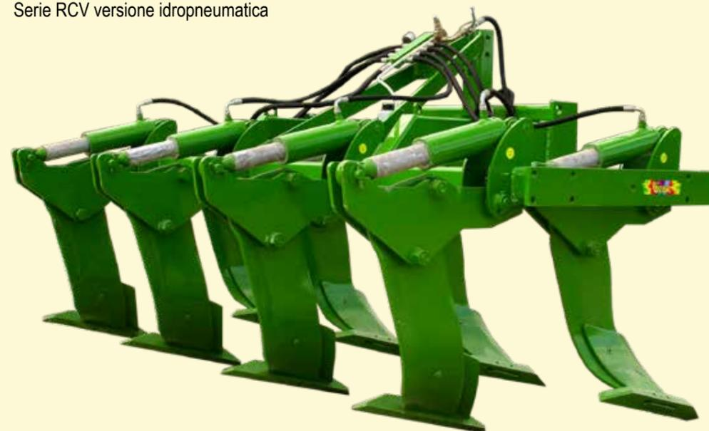
Arieggianti per vigneto e frutteto con due ancore curve laterali ed una dritta centrale.
