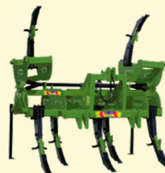
Versione con telaio a chiusura idraulica per trasporto su strada
