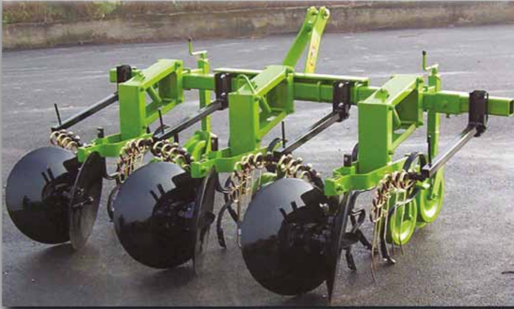
SARCHIATRICE PER PATATE CON VOMERI E RINCALZATORI (modulare)
