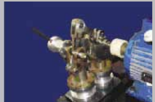
Cella di carico utilizzata per la sperimentazione dell'effetto del dente sul prodotto pendulo
