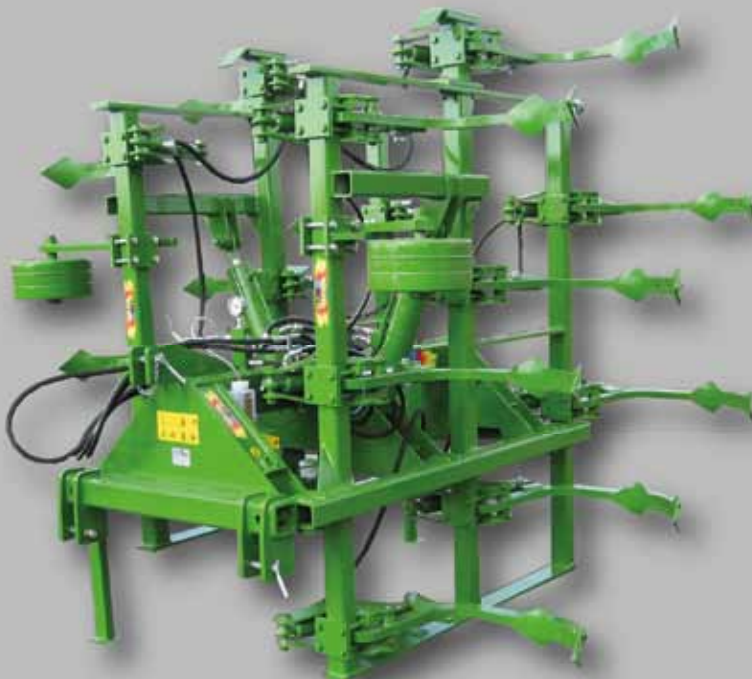
SERIE CI a 3 file Con ripiegamento idraulico in 2 pezzi Larghezza trasporto entro mt 2,50
